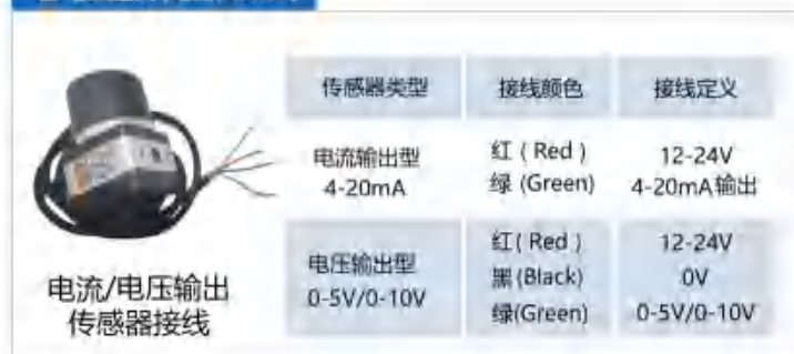
■ 接线定义 (电流/电压型)
