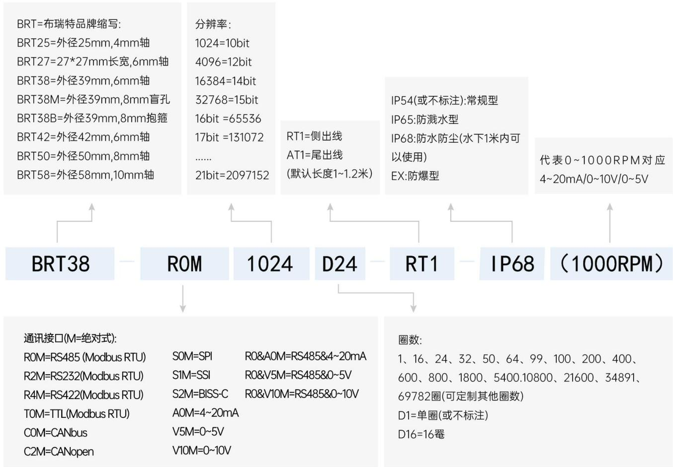
注1: 光电类型在通信接口前加P,例如光电RS485=PR0M
